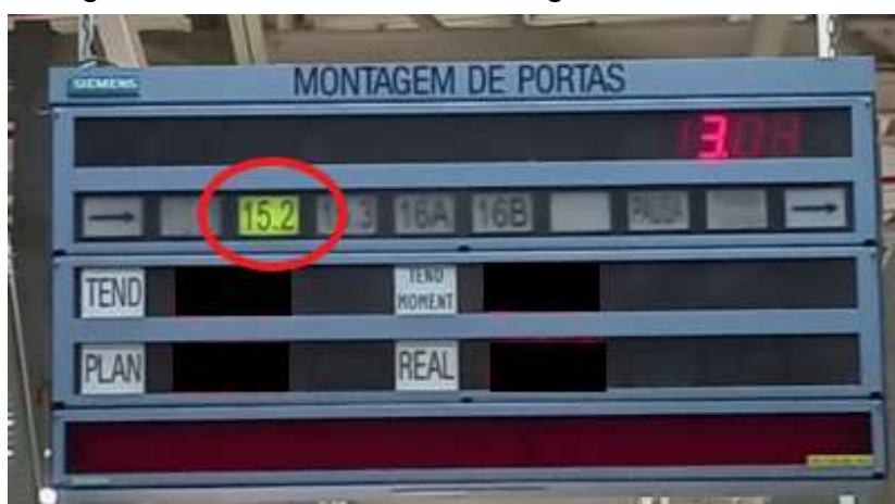
Figura 7 - Painel Andon - Montagem de Portas
