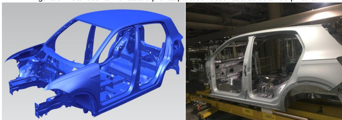
Figura 6 – Carroceria montada e pronta para ser destinada ao setor de pintura
