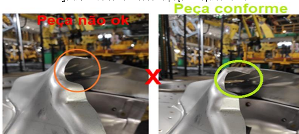
Figura 8 - Não conformidade na peça X Peça conforme.
