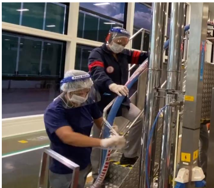
FIGURA 4 - FIXAÇÃO DA MANGUEIRA AO CORRIMÃO
