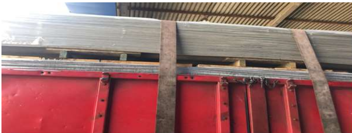
FIGURA 5– TELHA MAL EMBALADA
