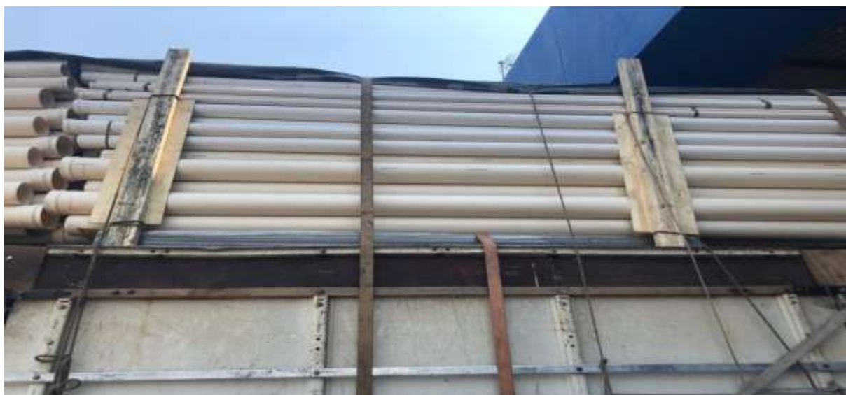
FIGURA 7 – MONTAGEM INCORRETA DA CARGA
