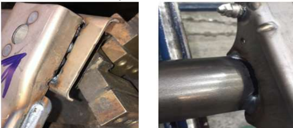
FIGURA 2 – PEÇAS COM DEFEITOS NA SOLDA
