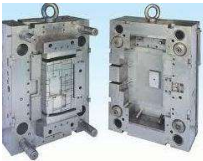
FIGURA 5 – INTERIOR DE UM MOLDE DE CAIXA DE BATERIA.
