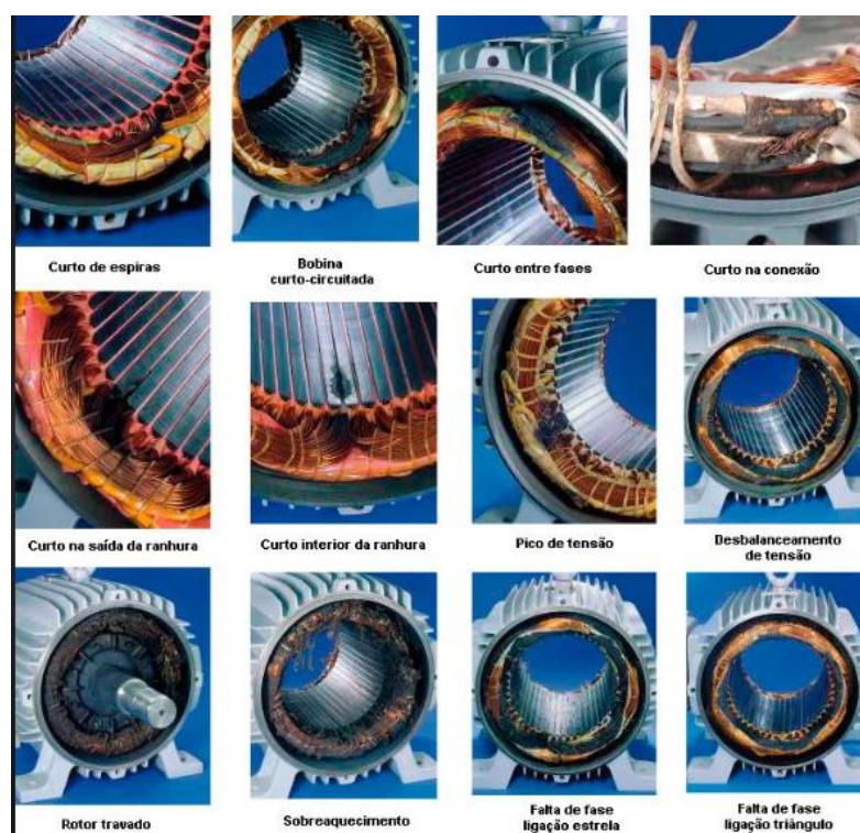
Figura 2 - Principais falhas em motores de indução trifásico.
