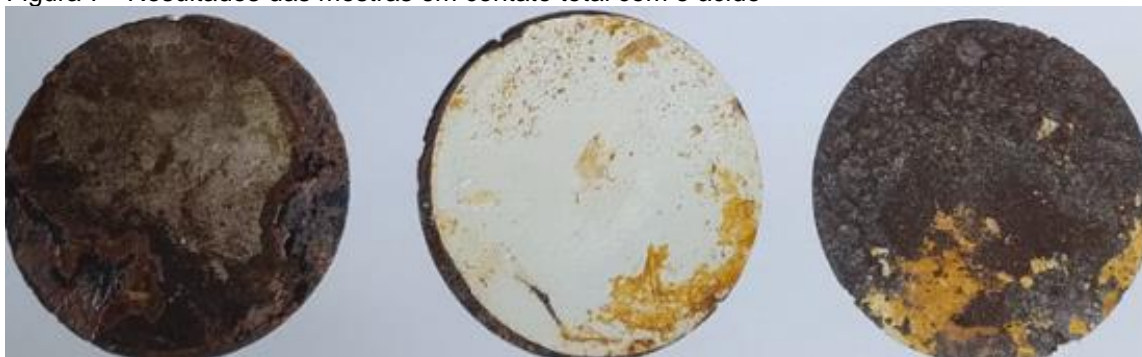
Figura 7 - Resultados das mostras em contato total com o ácido
