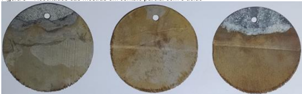
Figura 5 – Resultados das mostras em contato parcial com o ácido
