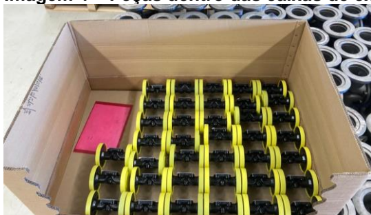
Imagem 4 – Peças dentro das caixas de exportação redimensionadas com proteção de flange
