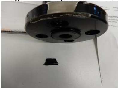
Imagem 2 – Corpos de válvulas com pintura danificada
