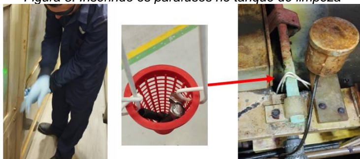
Figura 8: Inserindo os parafusos no tanque de limpeza
