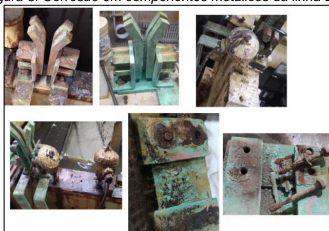
Figura 5: Corrosão em componentes metálicos da linha ECM
