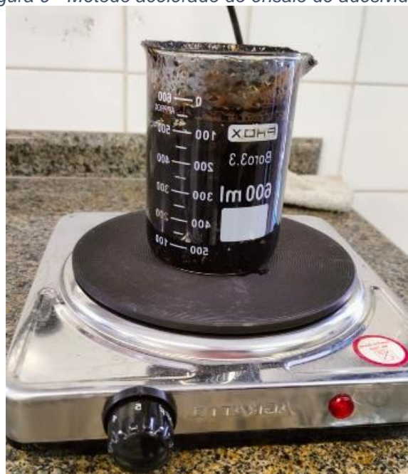
Figura 9 - Método acelerado do ensaio de adesividade
