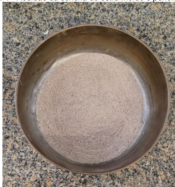
Figura 4 - Resíduo da concha de ostra moído e peneirado
