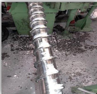
Figura 6. Rosca sendo Retirada do Cilindro para Limpeza (2020).
